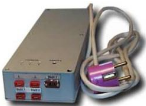
Рис. 5. Генератор шума Гном-3
